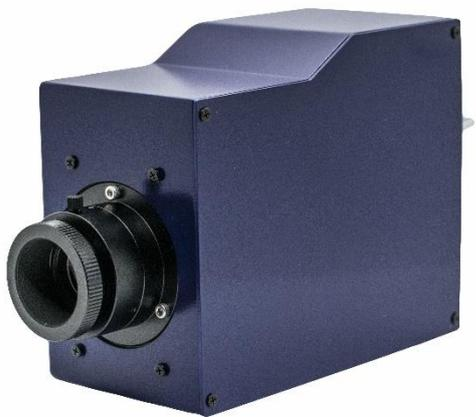
BV-C2950 はセンサを 2 種類搭載しており、一つは可視光の映像を、もう一つは放電現象を撮像します。そのためミラーを採用した分光イメージング技術を使い、400nm から 700nm の可視光と、200nm から 400nm の近紫外光領域とに分光しています。使用しているセンサは、可視光には 640x480 画素のセンサ、紫外光領域には超高感度 UV センサを採用しております。同一レンズで同じ視野で二つの映像を撮像しますので静電破壊の発生点を正確に知ることができます。
