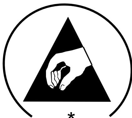
図 解説 2 包装ラベルの例 (IEC 61340-5-3:2010 及び edition2 で規定の包装ラベル)
