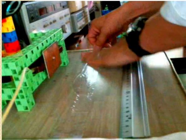
作業台上でフィルムを剥離してESD発生
