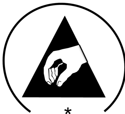
図 解説 2 包装ラベルの例（IEC 61340-5-3:2010 で規定の包装ラベル）
