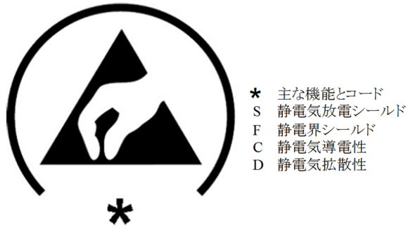
図 解説 3 包装ラベルの例（IEC 61340-5-3 Ed.2:2015 で規定の包装ラベル）
